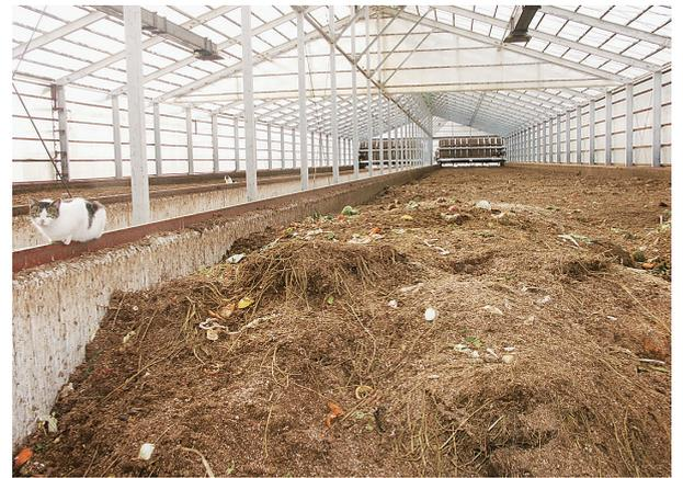
おが粉3㍓をきのこの廃培地6㍓に加えたのち、畜ふん10㍓、生ごみ3㍓の順に混合され、発酵を経て堆肥化する。発酵過程は2段階。写真は1次発酵の初期(上)と後期(下)
